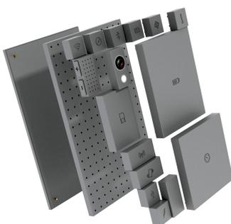
Abbildung 4.1: Konzept eines Modularen Smartphones
