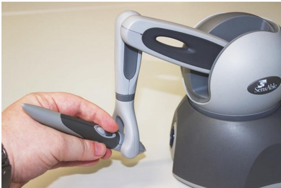
**Abb. 7:** Mechanisches Eingabegerät: Stiff von SensAble [img\_08]
