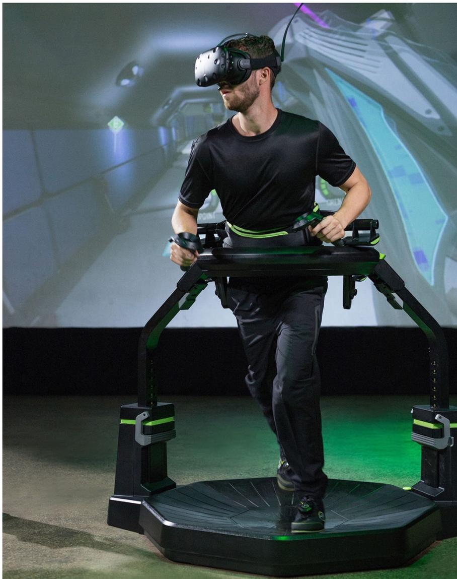
**Abb. 8:** Bewegungsplattform Omni by Virtuix [img\_09]
