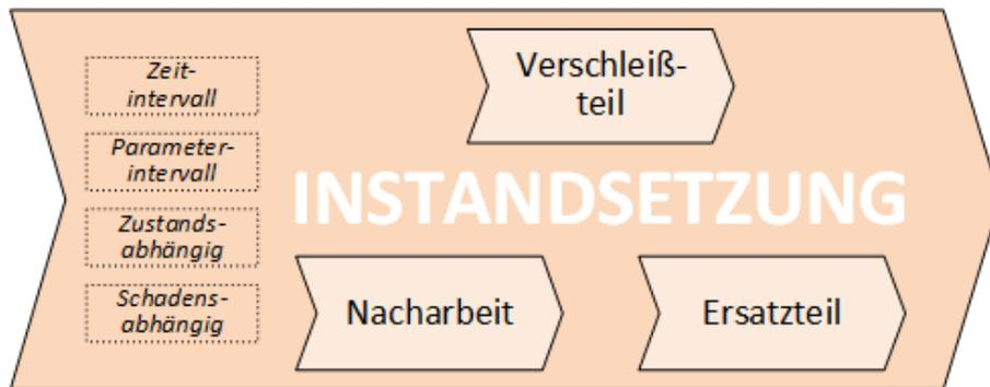
Abbildung 4-7: Vollständiger Instandsetzungsprozess mit Auslösern und Teilprozessen
