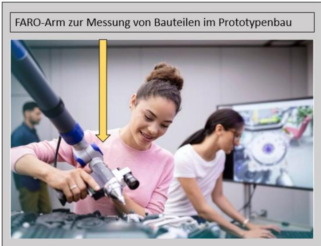
Abbildung 27: Daimler FARO-Arm Messung
