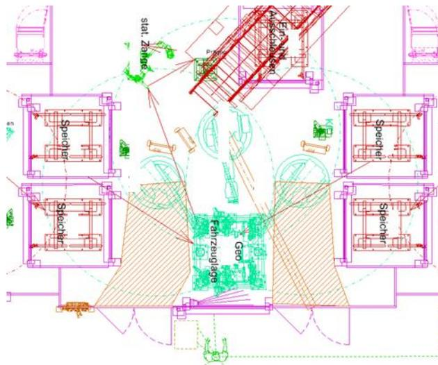
**Abbildung 18: beispielhaftes zweidimensionales Layout mit Fertigungsfluss (VOLKSWAGEN AG PLANUNG MARKE VOLKSWAGEN 2015)**
